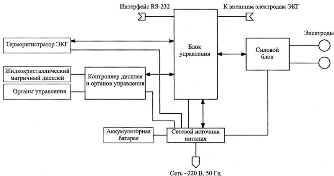
Рис.4. Функциональная схема внешнего дефибрилятора-монитора
